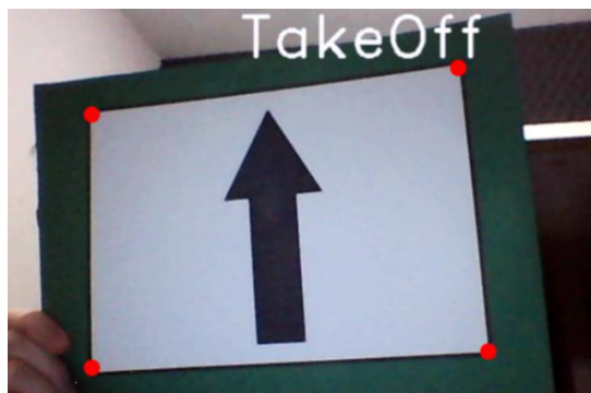
Figura 27 – Exemplo de comando visual enviado ao VANT para execução e controle do voo. Figura retirada do artigo [5].
