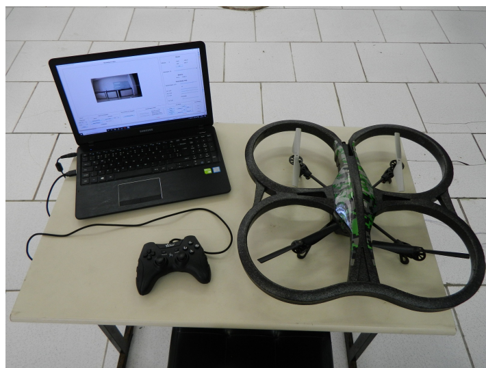
Figura 43 – Nesta figura, estão representados a aeronave, a estação de solo e o joystick para controle manual.
